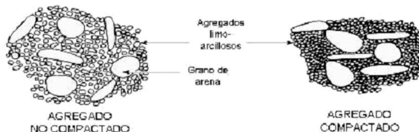
Fig 4.- Esquema de la compactación de agregados mostrando la disminución de la porosidad y la reorientación de partículas y poros.
